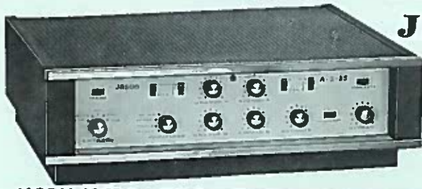
JASON A2 35 Ampli Préampli stéréo — 2 fois 35 watts 2 watts — de 15 à 100 000 p/s ± 1 dB — distorsion 0,02 % 35 watts — de 35 à 80 000 p/s ± 1 dB — distorsion 0,3 %
