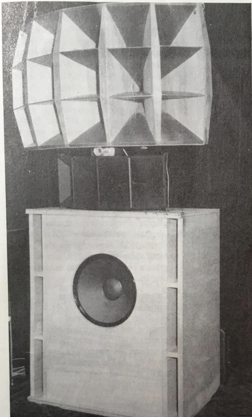
*Vue de face du système à quatre voies Onken avec le volumineux pavillon de bas médium de type véritable multicellulaire placé au-dessus du tweeter et du pavillon médium.*
